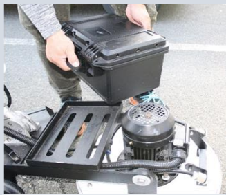
バッテリーボックスなので、 交換簡単！
